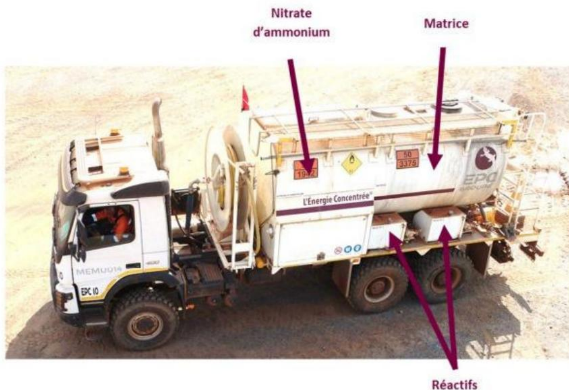
Annexe 1 : UMFE (Unité Mobile de Fabrication d'Explosif) : Blendex 70/30
