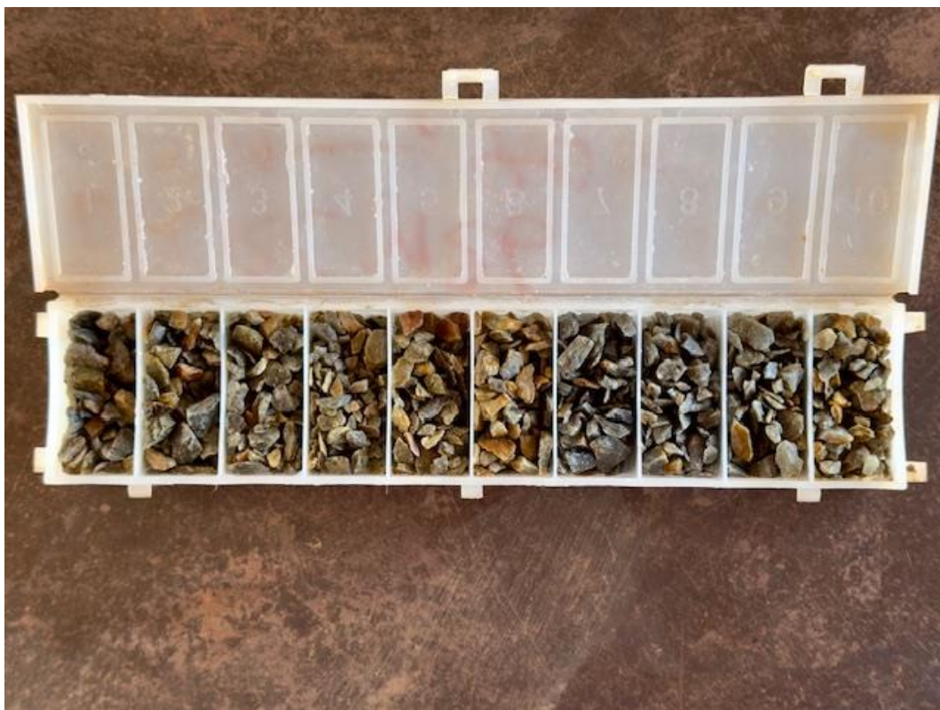
Figure 34 : Cutting box du forage LFARC 17-158 montrant des volcanites felsiques (VFEL)
