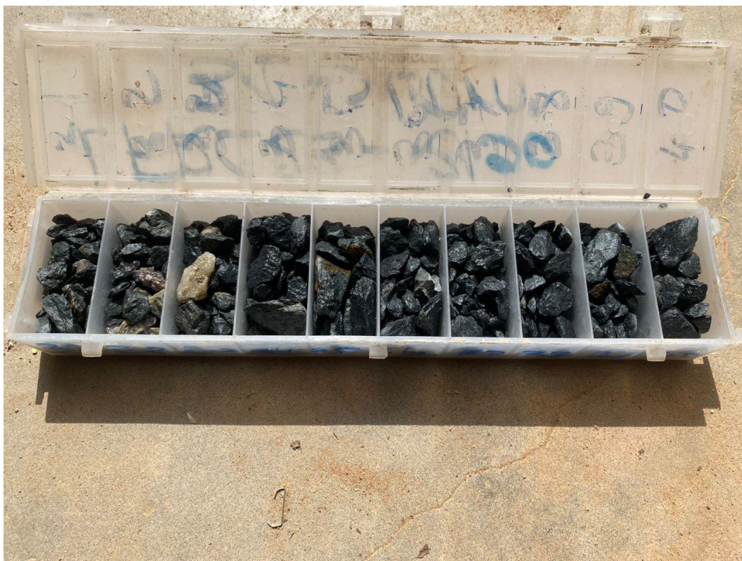
Figure 32 : Cutting box montrant des volcanite mafiques (VMAF)
