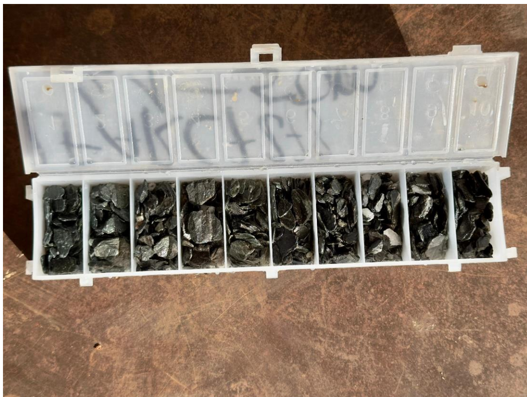
Figure 31 : Cutting box du forage LFARC 7873 montrant des intrusifs mafiques déformés (IMAF)
