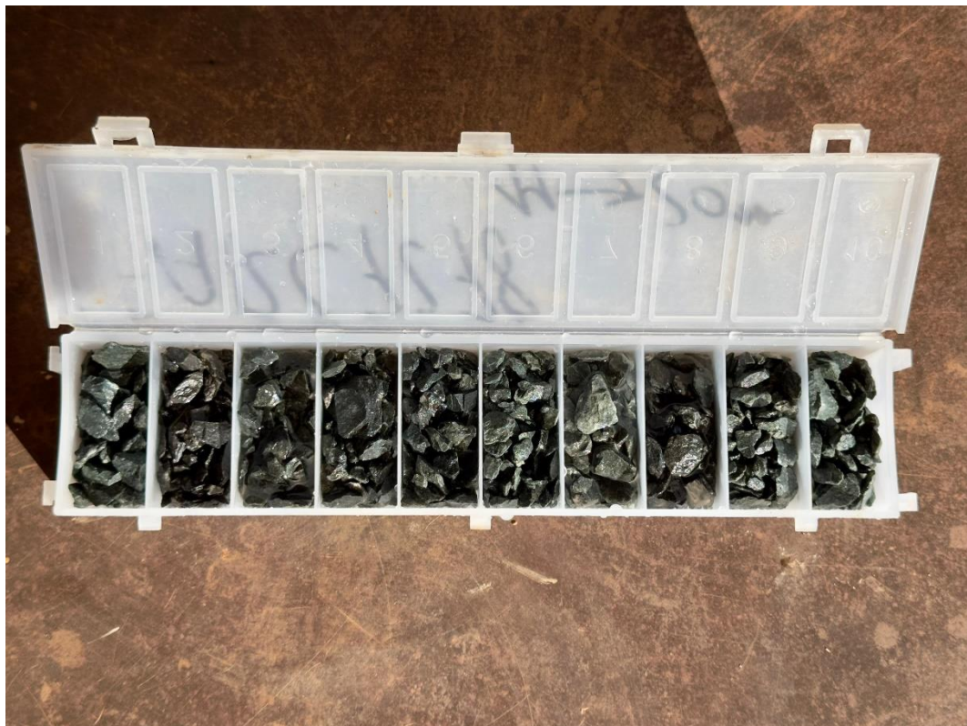
Figure 29 : Cutting box du forage LFARC 7873 montrant des intrusifs mafiques (IMAF)
