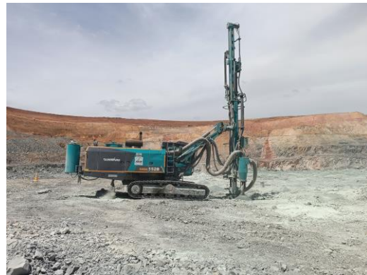
Figure 34 : Foreuse SUNWARD 152B en foration
