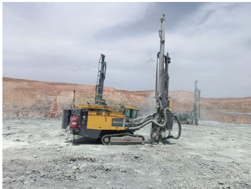
Figure 33 : Foreuse EPIROC D65 en foration
